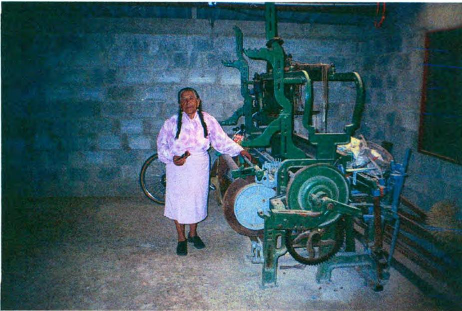
Telar mecánico inservible, le faltan aditamentos y un transformador
