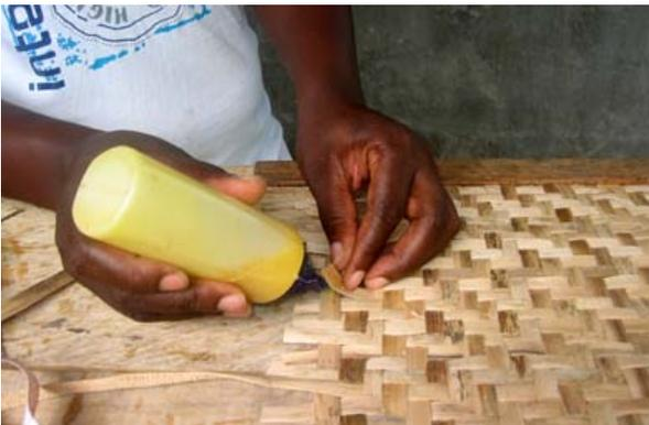
Se aplica bóxer en el perímetro del tejido para evitar que se desbarate al desmontarlo.
