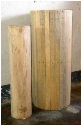
*Moldes para contenedores cilíndricos, armados por ensamble de tejidos.*
