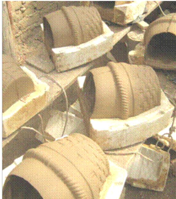
Moldes de yeso para Vaciado de Materas
